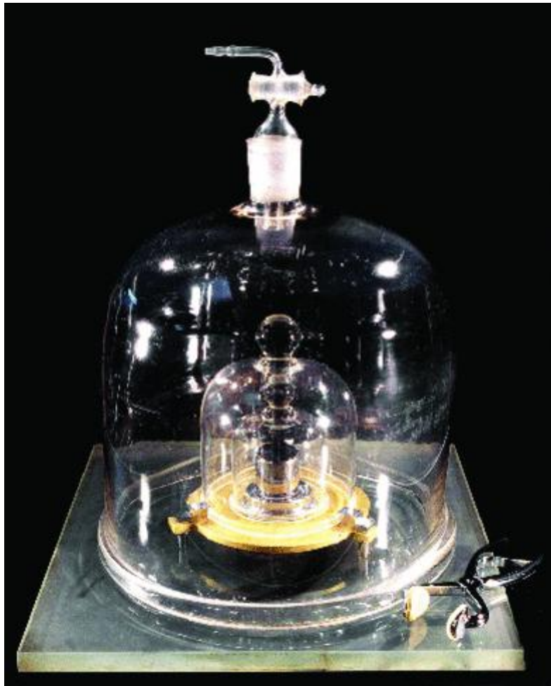
Figure 1 - Prototype international du kilogramme conservé dans l'air sous trois cloches. Dans cette photo, il s'agit d'un facsimilé du Prototype international, également en platine iridié
